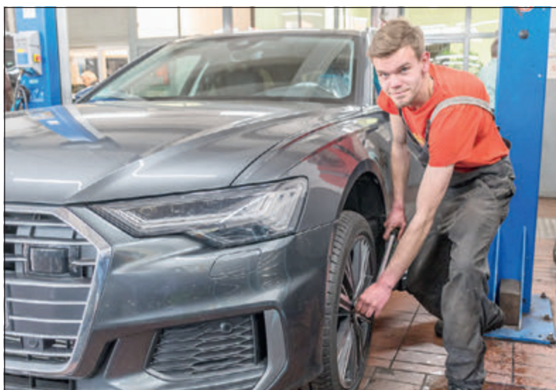
Niklas Kaiser wechselte die Reifen auf Sommermodus und setzte den Drehmomentschlüssel an.
